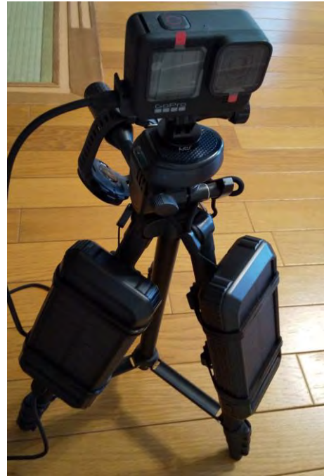
図1 長時間観測が可能な小型4Kカメラシステム
