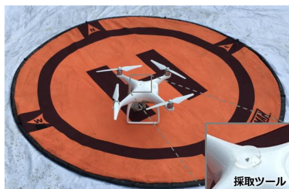
図3 雲粒採取に用いたクアッドコプター
