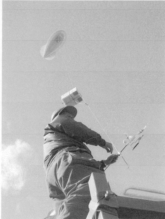
写真: JARE46 で実施した係留気球を用いたエアロゾル観測
